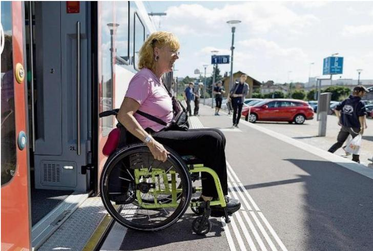
Niveaugleicher Einstieg mit max. Spaltbreite von 7,5 cm und max. Spalthöhe von 5 cm.
