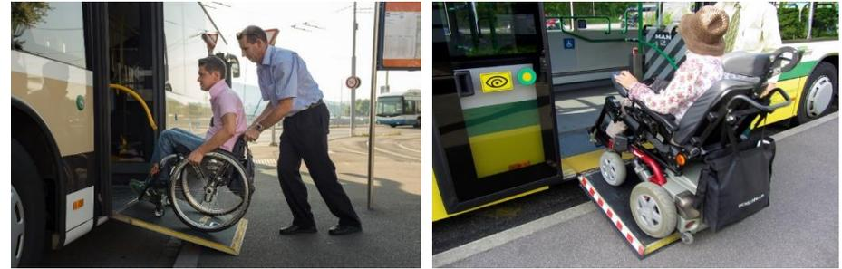
Erfordert den Einsatz der herausklappbaren Rampe im Bus auch wenn der Bus abgesenkt werden kann (Kneeling).
