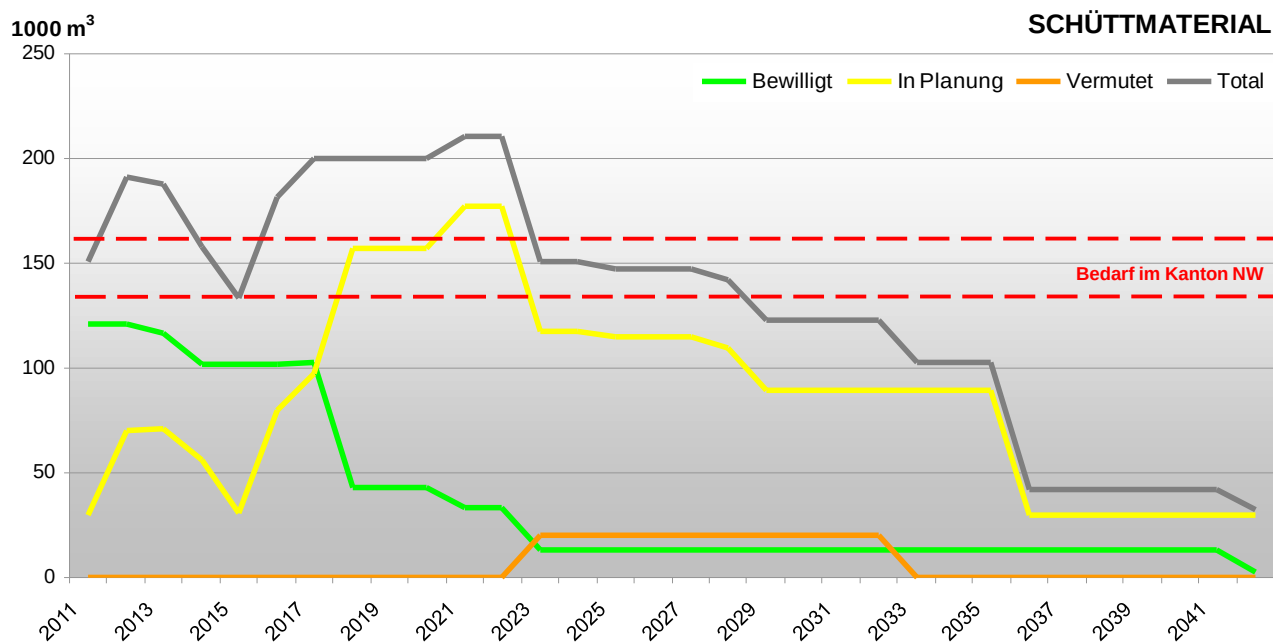
Abb. 3 Schüttmaterial. Entwicklung der Abbaureserven
