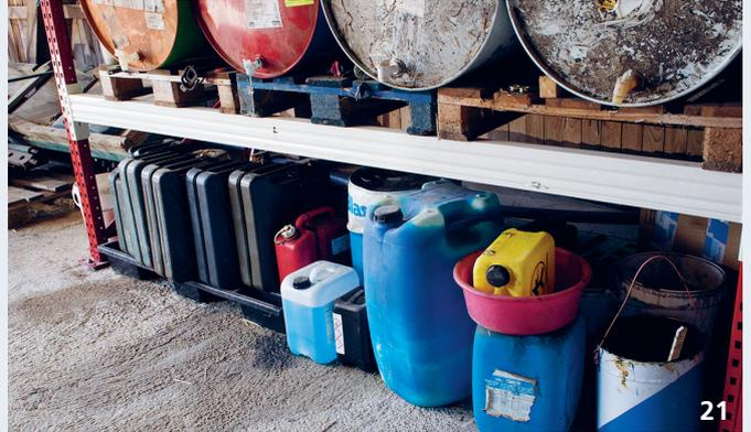
Bei Einzelgebinden mit Inhalt von mehr als 20 Litern fehlt eine Auffangwanne mit mindestens der Kapazität des grössten Gebindes. Es fehlt absorbierendes Material, mit dem ausgelaufene Produkte sofort gebunden werden können.
