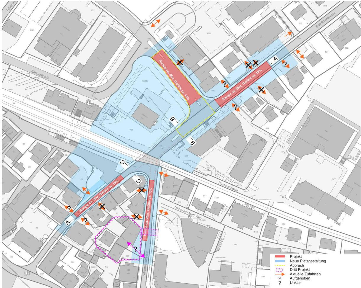
Abbildung 4-3: Neue Zufahrten Unterführung Buchserstrasse
