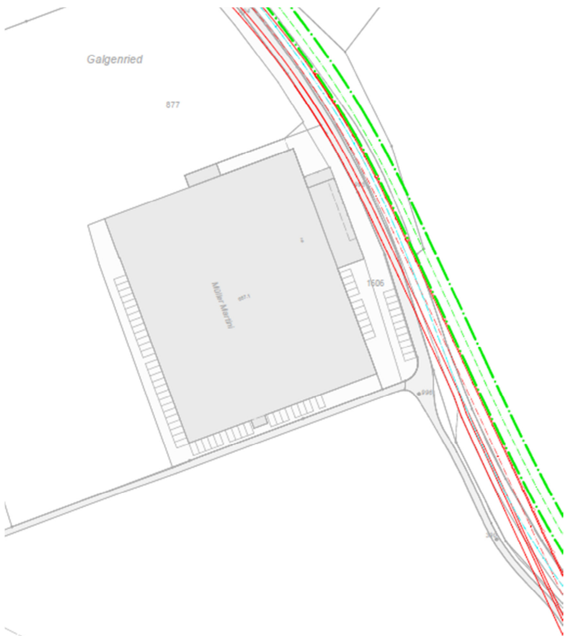
Abbildung 12: Verschiebung Zentralbahn und Entlastungsstrasse
