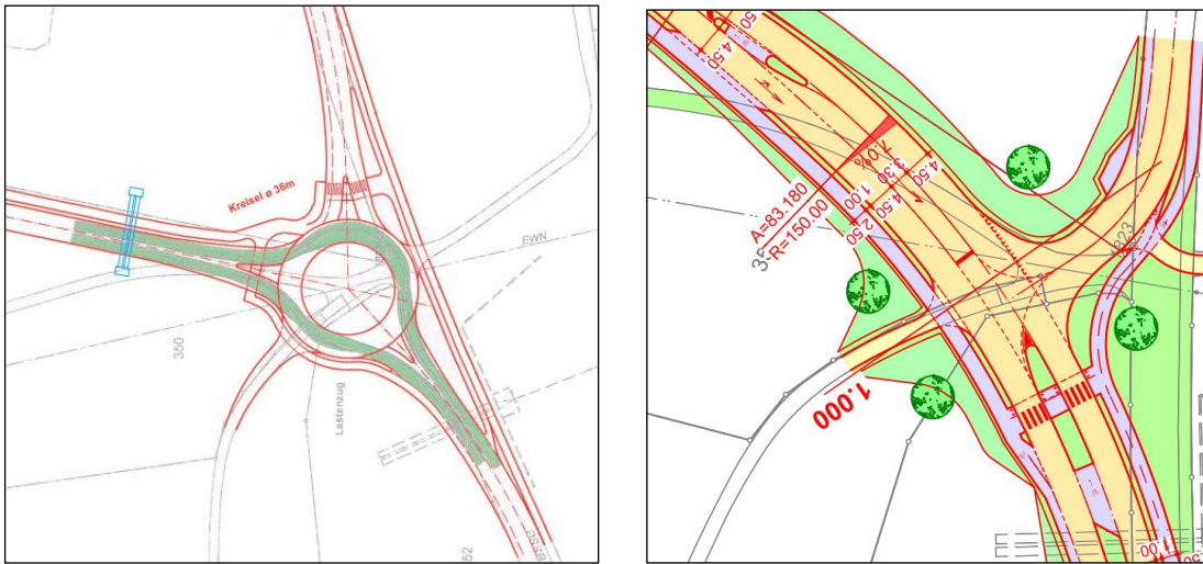
Abb. 8 Zu überprüfende Knotenformen Knoten Ennetmooserstrasse, links: Kreisel, rechts: T-Knoten (Quelle: [7])
