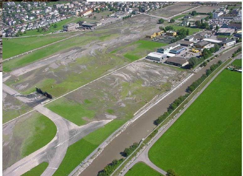
*Dosierte Energien im Entlastungskorridor verhindern Erosionen (Entlastungskorridor Buochs-Ennetbürgen)*
