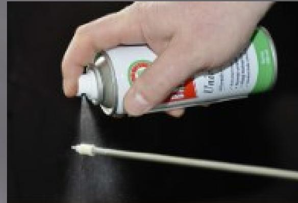
Einen Filz mit Waffenöl tränken und durchziehen. So wird der saubere Lauf vor Korrosion geschützt. Anschließend mit sauberen Filzen trocken wischen.
