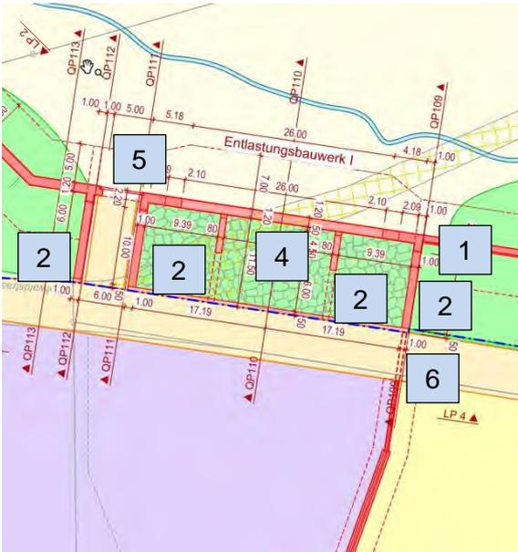
Abbildung 7: Grundriss des Auslaufbauwerkes I (Quelle: Schubiger AG)
