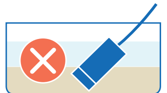
Abbildung 2: Pumpenmontage, Pumpe darf nicht im Schlamm liegen
