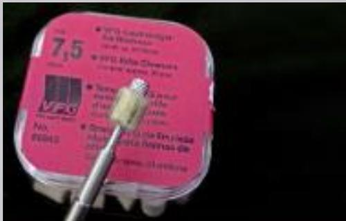
Filze für das passende Kaliber können Bürsten und Patches ersetzen.
