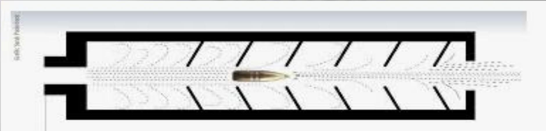
Im SD werden die austretenden Gase verwirbelt. Die heißen Verbrennungsgase hinter dem Geschoss vergrößern ihr Volumen schlagartig und kühlen ab. Die Verwirbelung und die Abkühlung tragen dazu bei, dass der SD den Schussknall um bis zu 30 Dezibel reduziert.
