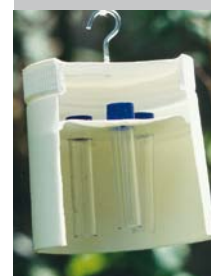
Aufgeschnittene Aufhängevorrichtung mit 3 Passivsammler- Röhrchen. (ø = 10.4 cm, Höhe = 11 cm)
