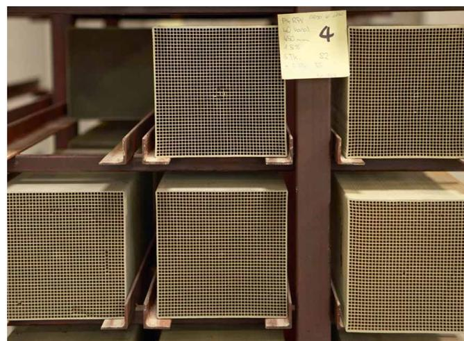
*Diese Keramikmodule sind bereit für den Einbau in grosse Partikelfilter. Die Dieselmotorspartikel werden im Innern der Keramikwaben zurückgehalten und periodisch abgebrannt.*
