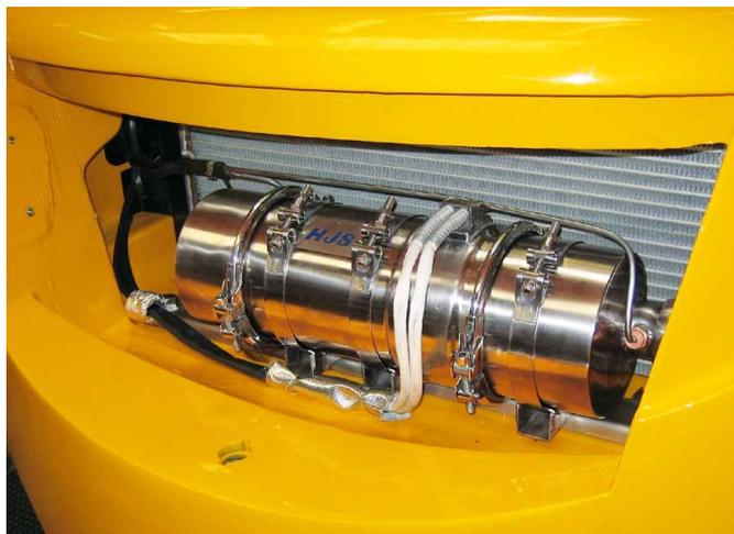
*Dieselbetriebene Arbeitsmaschinen wie dieses Flurförderfahrzeug, die in gedeckten Hallen oder geschlossenen Innenräumen zum Einsatz kommen, sollten zum Schutz der Beschäftigten über ein effizientes Partikelfiltersystem verfügen.*
