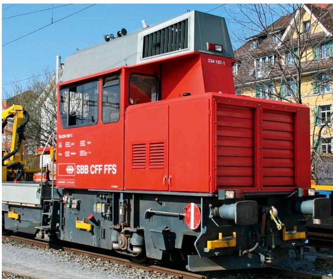
Bei den dieselbetriebenen SBB-Baudienstraktoren des Typs Tm 234 ist das Abgasreinigungssystem aus Platzgründen im Dachaufbau untergebracht.
