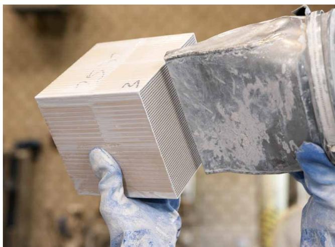
*Produktion von Keramikwaben als Filtermedium für leistungsstarke Partikelfilter. Schweizer Firmen gehören auf dem Gebiet der Abgasreinigung von Dieselmotoren zu den Pionieren.*
