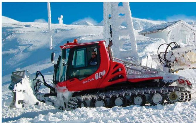
*Klimatischer Härte-test für das Abgasreinigungssystem im Hochgebirge: Obwohl saubere Pistenfahrzeuge wie die Produkte des deutschen Weltmarktführers Kässbohrer zum Teil auf 3000 Metern über Meer und bei Aussentemperaturen weit unter dem Gefrierpunkt im Einsatz stehen, werden die erforderlichen Abgastemperaturen für den spontanen Abbrand der im Partikelfilter angesammelten Russteilchen problemlos erreicht.*
