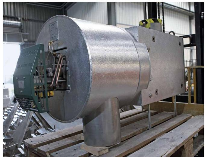
*Gesetzeskonforme Partikelfiltersysteme für leistungsstarke Dieselmotoren, wie sie etwa in Schiffen und Lokomotiven zum Einsatz kommen, müssen mindestens 97 Prozent der Russpartikel abscheiden.*
