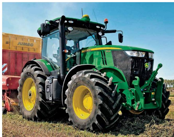
*Der amerikanische Traktorenhersteller John Deere erreicht den gegenüber früheren Abgasvorschriften wesentlich strengeren Partikelgrenzwert der EURO-Abgasnorm III B für neue Motorentypen durch den standardmässigen Einbau eines geschlossenen Partikelfilters.*
