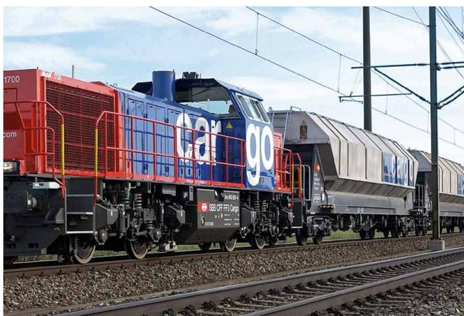
*Diesellokomotiven wie die leistungsstarke Am 843 werden auf dem schweizerischen Schienennetz vor allem für den Rangierdienst und im Güterverkehr eingesetzt – so etwa für Transporte von Wagenladungen auf Zubringergeleisen ohne Fahrleitung. Seit 2004 verfügen alle neuen SBB-Lokomotiven mit Dieselantrieb über einen Partikelfilter.*
