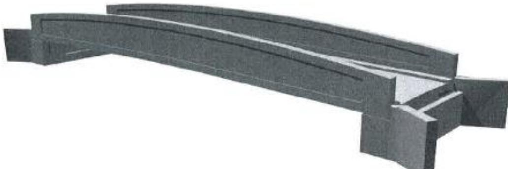
Abbildung 3: Trog-Brücke entsprechend dem Variantenentscheid
