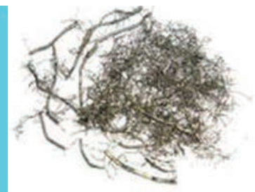
Kein Abfall: Gummimehl und Metallfraktion in Reinform.
