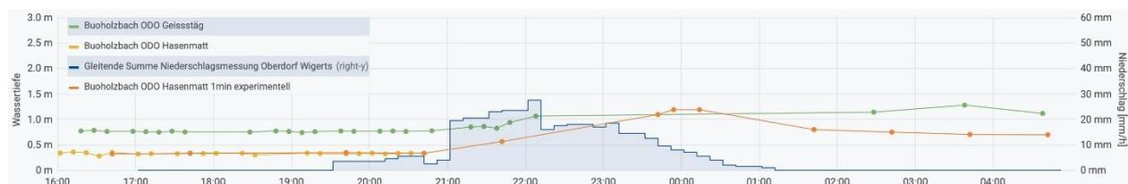
Fig. 11: Niederschlagsmessung der Station Wigerts (Buholzbach), aufsummierte 10min-Werte [20]
